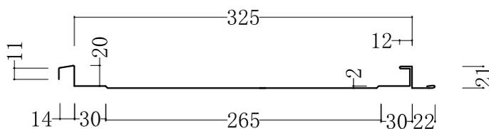
立平 吊子なし 働き幅 m幅半切り440mm 三幅半切り397mm
