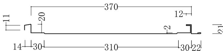
吊子一体型立平 働き幅 325mm (スリッター幅 457mm 三幅半切り)
