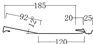
**A-2型** 働き幅 215mm (スリッター幅 334mm m幅三つ切り)
