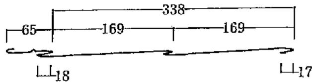
A T 2 働き幅 305mm (スリッター幅GL455mm ステン457mm)
