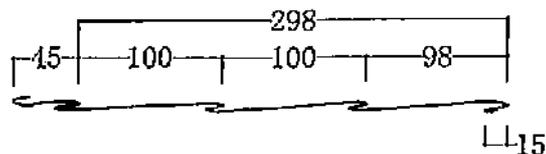
AT 1 働き幅 200mm (スリッター幅 GL294 ステン296)
