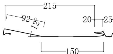
**B 型** 働き幅 330mm (スリッター幅 457mm 三幅二つ切り)
